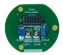
电源的正极接入负载(如二次表)的电流输入端,负载(如二次表)的电流输出端引线接在远传变送器内接线端子排的+24V上,
